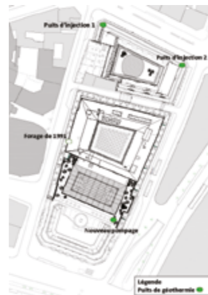
Implantation des forages de géothermie dans le sous-sol de la Samaritaine • ©La Samaritaine
