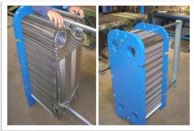
► Echangeur à plaques et joints
