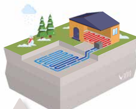
Schéma de principe du captage horizontal
