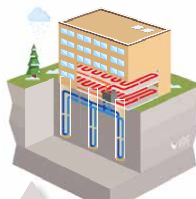
Schéma de fonctionnement des fondations thermoactives
