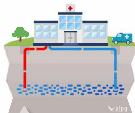
Schéma de principe du captage sur nappe
