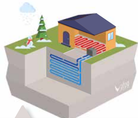
Schéma de principe d'un mur géothermique
