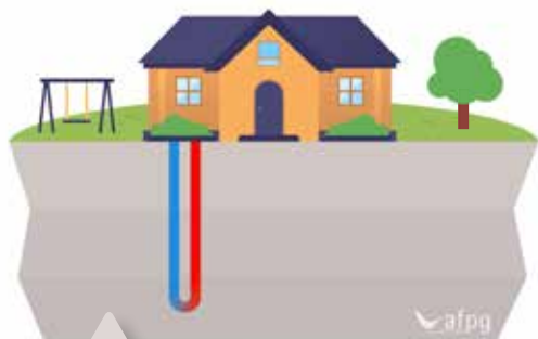
Schéma de principe du captage par SGV
